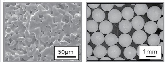
Li<sub>2</sub>TiO<sub>3</sub> 펠블의 형상 및 미세구조 ▲
