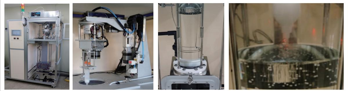
증식재 펠블 성형 자동화 장치, 펠블 제조 능력(Li<sub>2</sub>TiO<sub>3</sub>) : 50 Kg/year ▲
