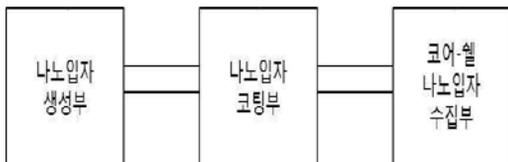
[코어-셸 구조를 갖는 나노 입자의 인시류 제조 시스템 블록도]
